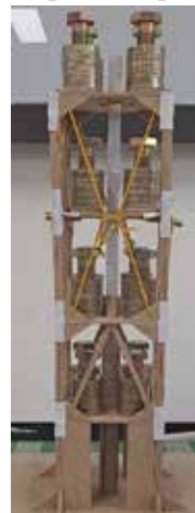
보완점: 내부 코어 강성 증가 (접착력 및 접합부 강화)
